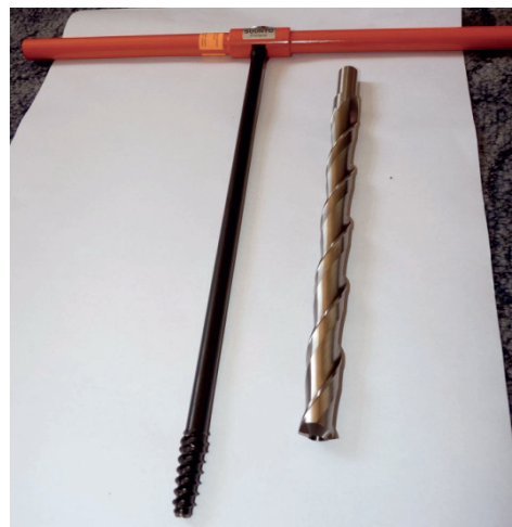
3 pav. Dendrochronologinių medienos gręžinėlių ėmimo grąžtai: augančių medžių (kairėje) ir sausos medienos (dešinėje)
