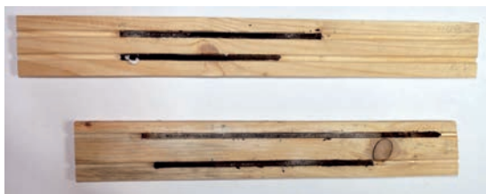
5 pav. Medienos gręžinėliai, paruošti rievių pločiui matuoti mikroskopu
